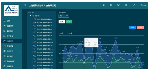
数据报告 同一图表中分析一幢建筑的多种能源类型，或 分析一幢建筑多个用能系统的占比情况；
