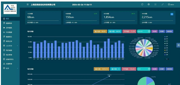
首页看板 直观显示单体建筑内不同能源类型的分项消耗或同类型能源年、月、日总消耗；
