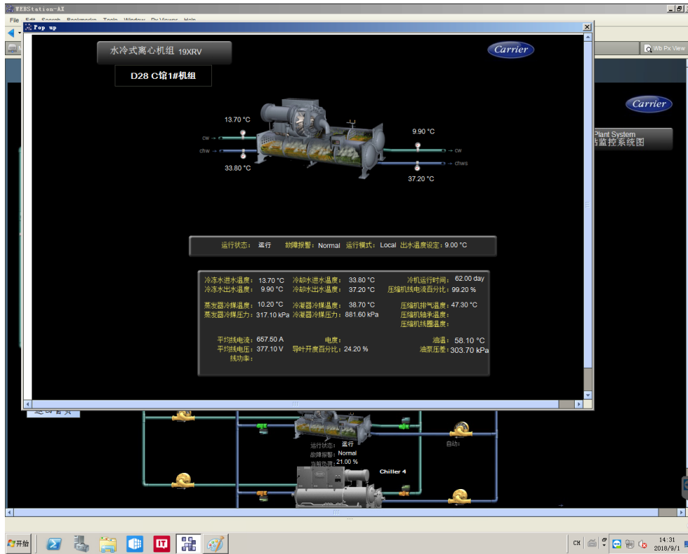
图 6 地下室 4 台离心式机组集成画面
