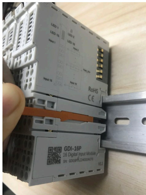
图五 卡片式IO安装在导轨后取出示意： 将橙色条向外拉出，即可取出模块。
