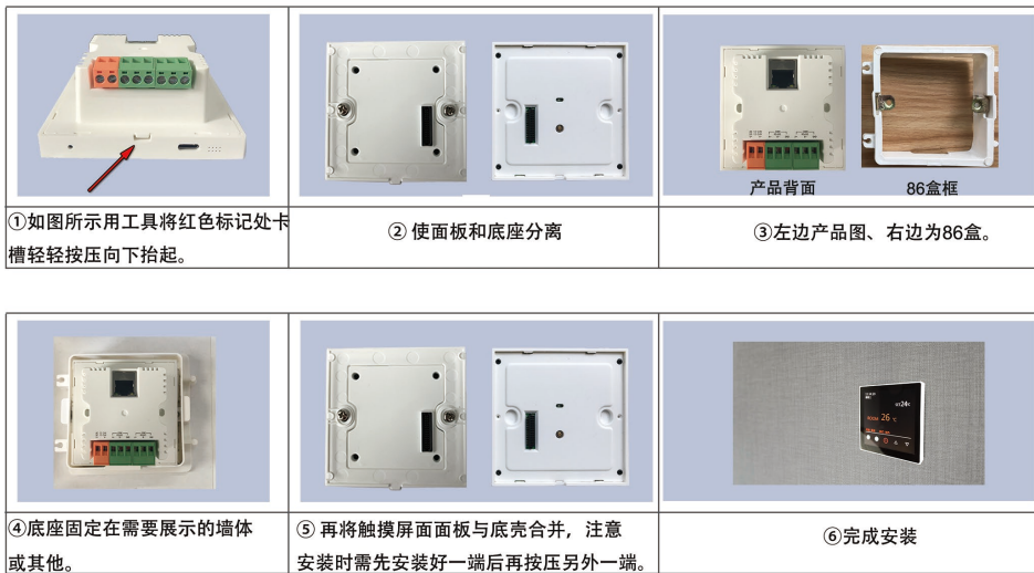
图四 86盒安装（需提前将86盒嵌入墙体后再根据安装顺序完成安装）
