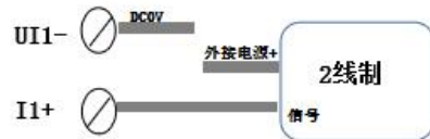
图三 模拟量输入接线示意图
