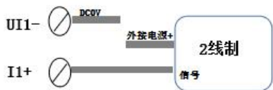
图二 模拟量输入接线示意图
