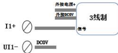
图三 模拟量输入接线示意图
