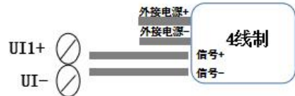
图八 模拟量输入接线示意图
