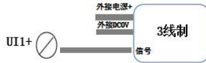
图六 模拟量输入接线示意图
