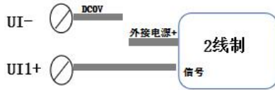
图六 模拟量输入接线示意图
