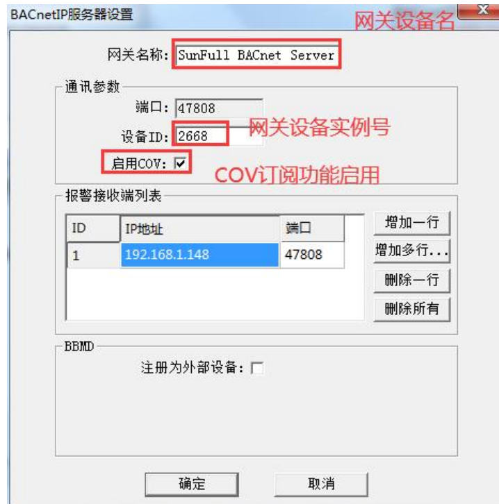
图 3-7-2 BACnet 服务器参数设置
