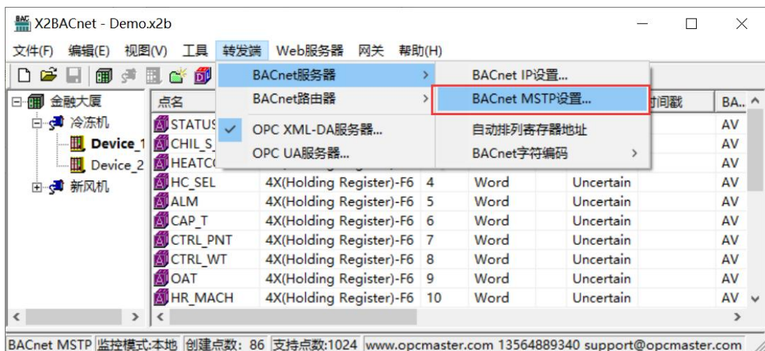
图 3-7-4 选择 BACnetMSTP 设置
