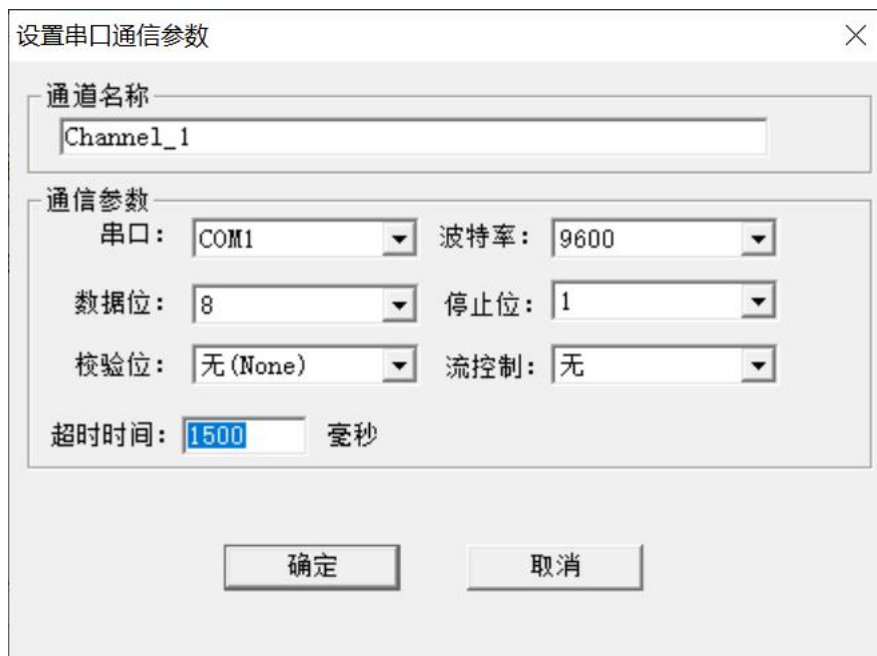
图 3-4-2 设置通道参数
