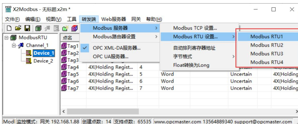
图 3-7-4 选择 ModbusRTU 设置
