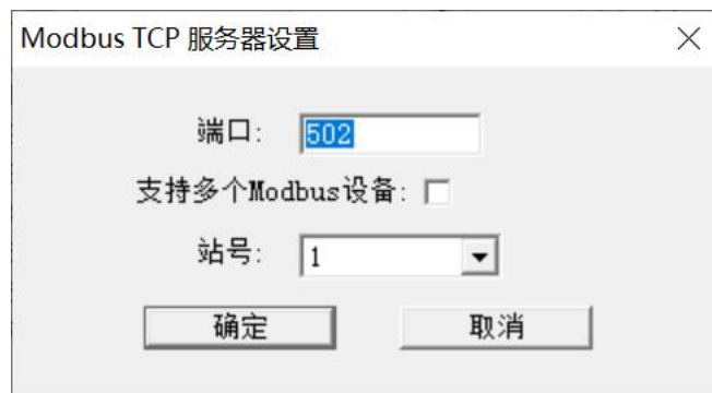
图 3-7-2 ModbusTCP 参数设置
